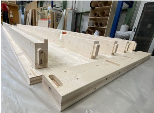
Przykład indywidualnego opracowania NOVATOP OPEN – Złącze czopowe.
