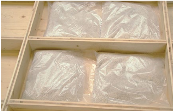
Wypełnienie wapienne (40, 60, 80 kg/m 2 ).
