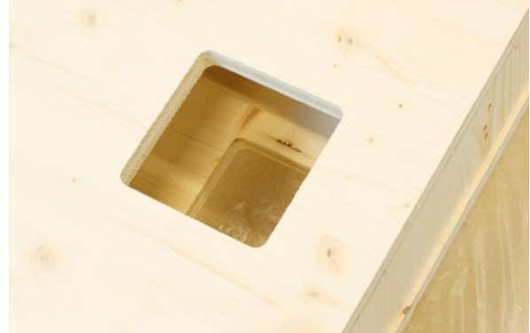
Frezowanie otworów kwadratowych, wykonanie z promieniem.
