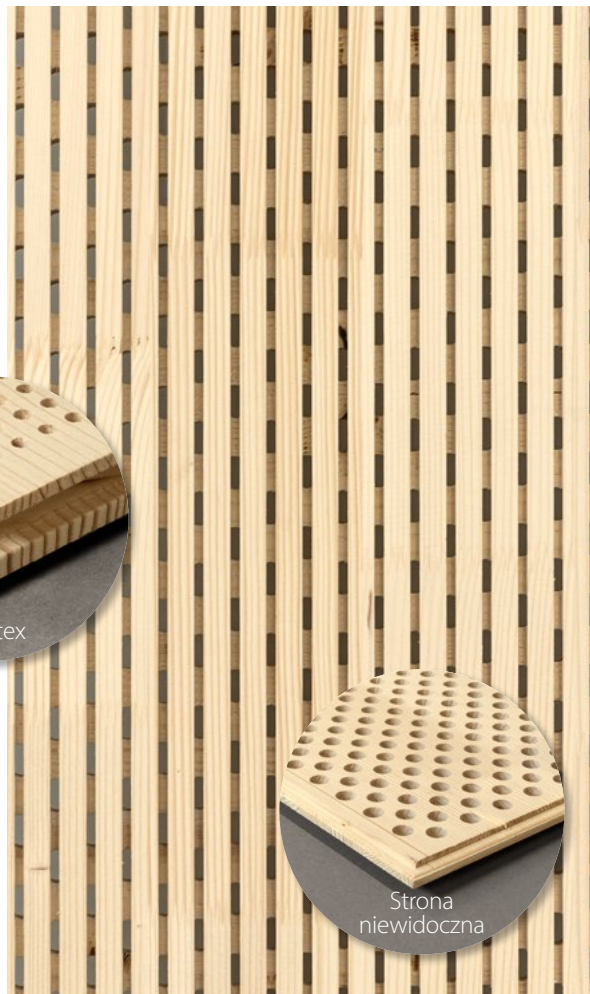
Profil S/L - rowkowanie na stronie widocznej 4/12, wiercenie na stronie niewidocznej 16/32-32
