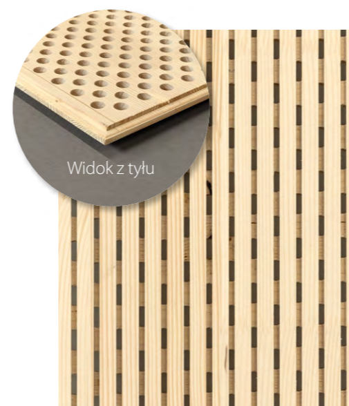
Profil S/L – widoczna strona frezy 4/12, niewidoczna strona wiercenia 16/32-32
