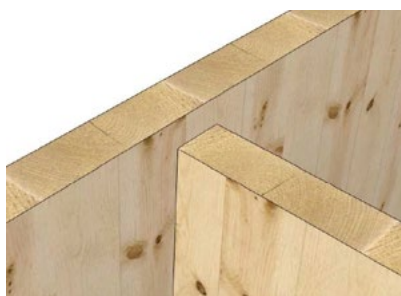
DETAIL OF A LONGITUDINAL JUNCTION 62 – WITH OVERLAP / Detal wzdłużnego łączenia 62 – z przeplataniem
