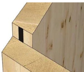
DETAIL OF CORNER JUNCTION (cca 135°and more), IW 124, 84, 62 / Detal,łączenia narożnego (ok. 135° i więcej) 124, 84 i 62
