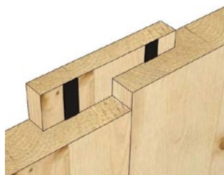
DETAIL OF A LONGITUDINAL JUNCTION 62 – WITH FASTENER / Detal wzdłużnego łączenia 62 – z nakładką
