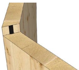
DETAIL OF CORNER JUNCTION (cca 135° and more), IW 124, 84, 62 / Detal,łączenia narożnego (ok. 135° i więcej) 124, 84 i 62
